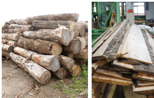
写真1 広葉樹低質材から製材用に選木した原木（左）と耳付きの挽き板（右）
