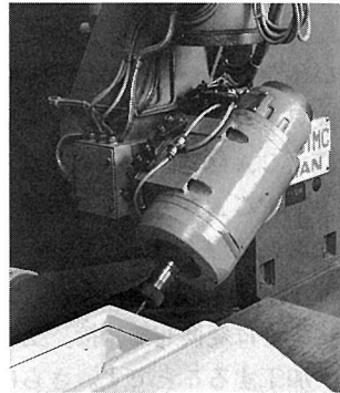
写真6 樹脂カバーの切り抜き・仕上加工
