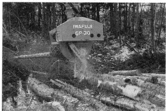
イワフジの林業機械<GP30A>プロセッサ（玉切り）
