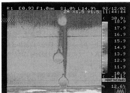
写真2 グローブ温度計に床面から受けた輻射熱
