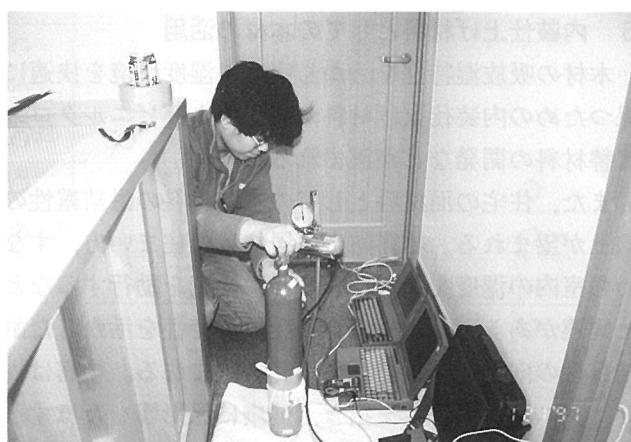
住宅室内の自然換気回数の計測風景
