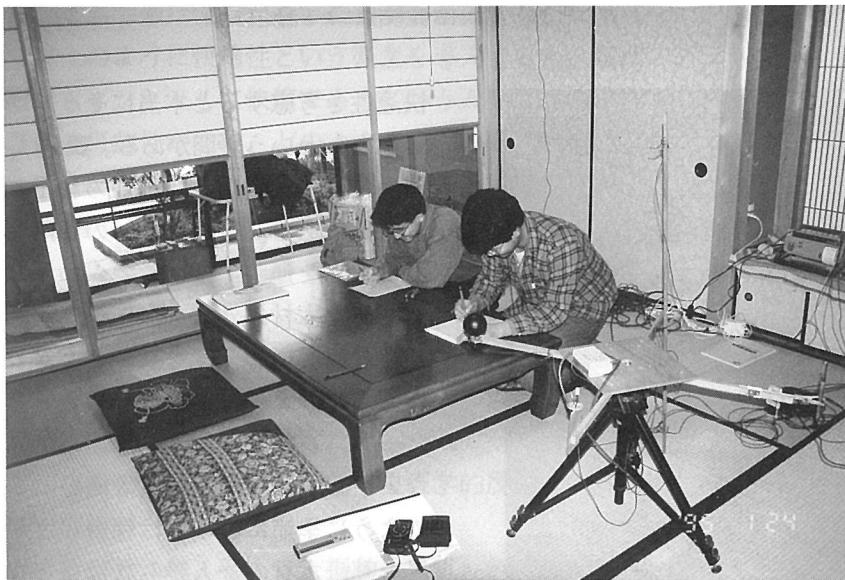
住宅室内の快適性を評価するためのPMV計測と官能検査風景
