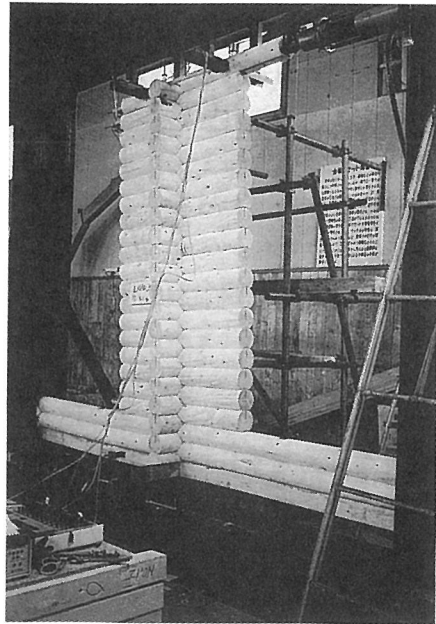
図-7 校倉壁体の水平加力試験の様子
