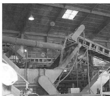
粉碎され、釘などの金属片を分別されたパーティクルは写真の水分別機にかけられます。さらに風力選別にかけて、製紙原料として出荷します。
