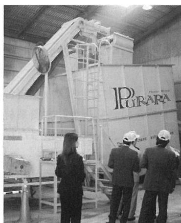
プラスチックプラントは廃プラスチックを溶かして杭状の角棒を作る工場です。
