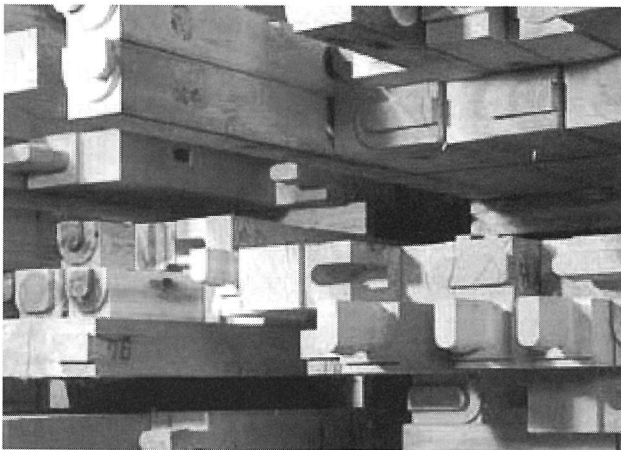
写真1 プレカット加工済みの住宅部材
