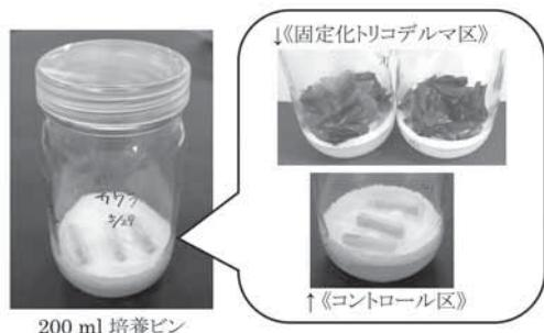
写真1 固定化トリコデルマの木材保存能力の測定
