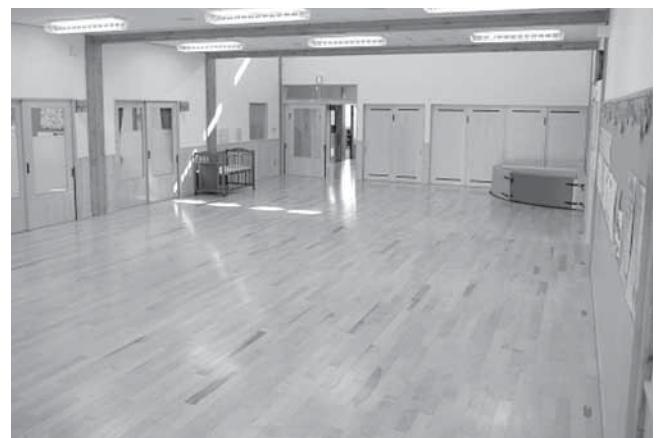
建物はカラマツ大断面集成材を使用した木造平屋建て延べ床面積662m<sup>2</sup>で、木材総使用量155m<sup>3</sup>のうち98%を町内の山林から生産されたカラマツ・トドマツを使用しています。これは間伐した町産材を山土場から徹底管理するとともに当麻町森林組合の製材工場
