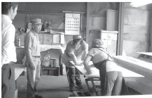
（タモの突板を合板表面に貼る作業）
