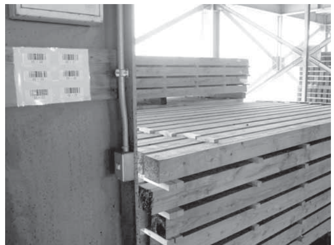
写真2 バーコードによりロケーション管理されたストックヤード
