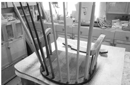
分解後、木地加工で製作したスポークを取付け
