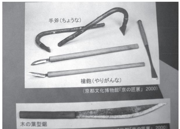
写真2 日本の大工道具（手斧・槍鉋・木の葉型鋸）
