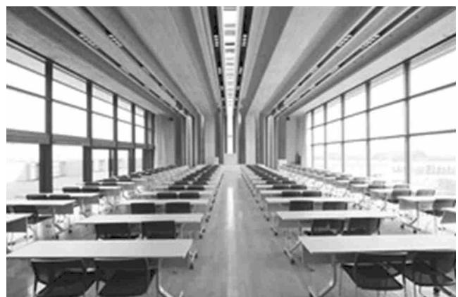
それからもうひとつ、今度は建築構法から考えますと、最上階に屋根を作るためにはその下の床を作つてから作業に入ります。それから最上階の工事を始めるわけですが、木材ですとそこには水を要する湿式のウエットな工事がなくなるわけです。通常とおりコンクリートを打つとそこは水気を使った工事が残るため、その下の工事が始めづらいわけです。しかし、最上階を木造にした瞬間に、内装も速やかに工事が始められます。つまり、工期が短縮できるメリットもあるということです。木材会館ではすべての構造材を木材に置き換えるのではなくて、最上階を木材に置き換えてみてはどうかということを検討しました。そうすると、木材でありながら工期を短縮して、あわよくば値段も安くできて、そして特殊な用途（ここでは貸しホール）にもなじみます。木材会館は、「木材会館」とは名乗っていますが、オーナーである東京木材問屋組合さんの本部が入っているのはその中のほんの一部であ
