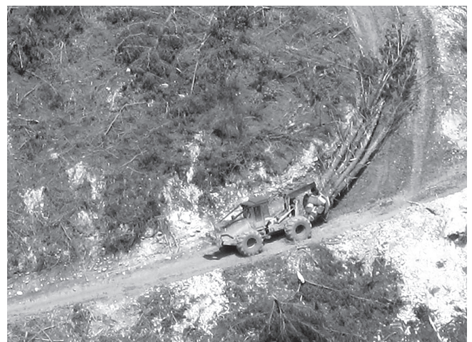
写真2 グラップルスキッドによる全木集材（ネルソン市周辺）
