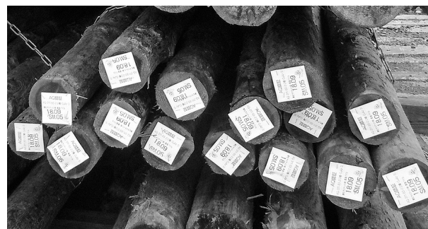
写真4 全ての防腐丸太に品質管理票を添付
