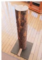
釧路産の小丸太をくり抜き、ポンプ式のアルコールボトルを入れました。足元の板を踏むと、ノズルからアルコールが噴霧される仕組みになっています。
