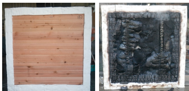
写真1 板張り防火構造の耐火試験 左：加熱前、右：30分加熱後 加熱面の大きさは1×1m
