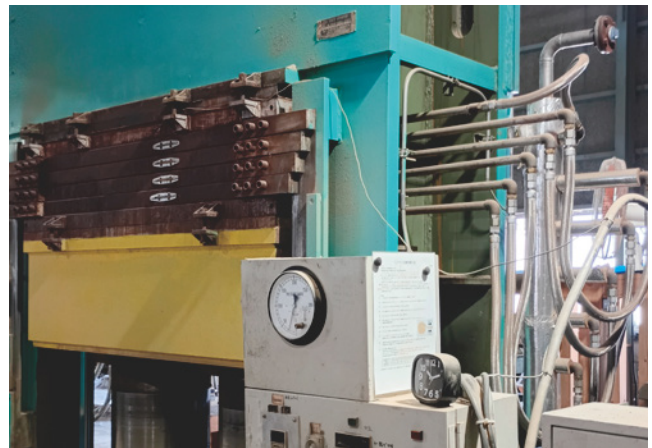
写真5 2023年に導入した実大・5段プレス 加熱面1×2m
